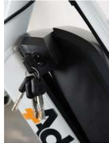
figure 9- Enclenchement de la batterie sur son socle
