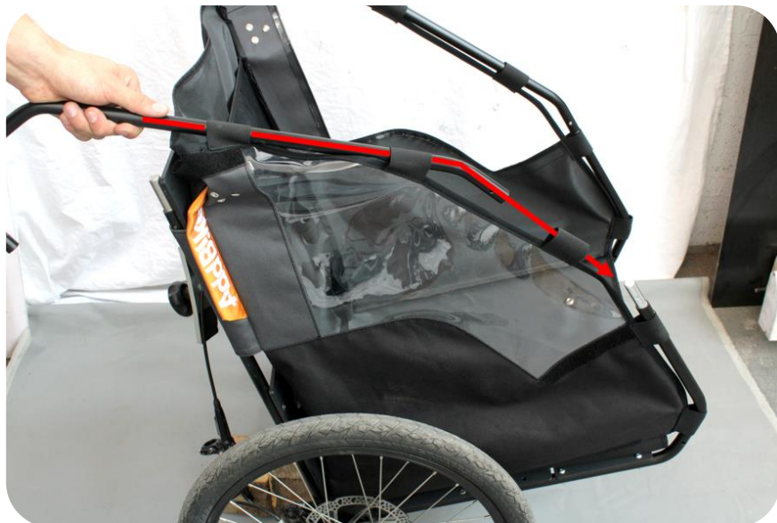
Abbildung 9 – Einführen der Oberrohre durch die Textilschlaufen
