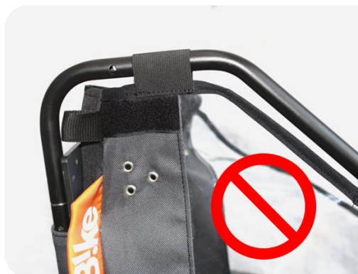
Abbildung 10 – Schieben in die unelastischen Schlaufen vor Zusammensetzung der Rohre
