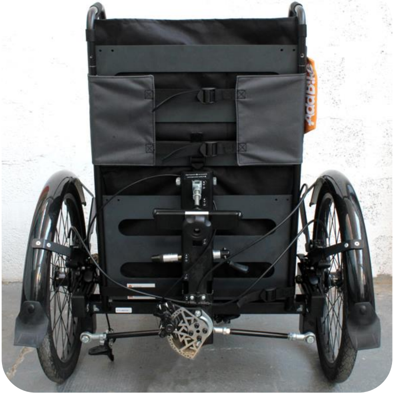
Abbildung 14 – Befestigung der Gurte an der AddBike+-Rückenlehne
