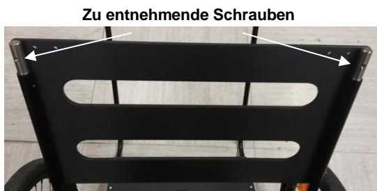
Abbildung 4 – Zu entfernende Schrauben der Rückenlehne und Ladefläche
