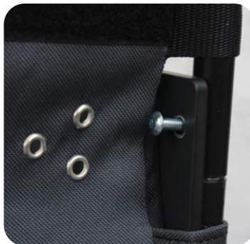
Abbildung 12 – Wiederanbringung der Schrauben an der Rückenlehne
