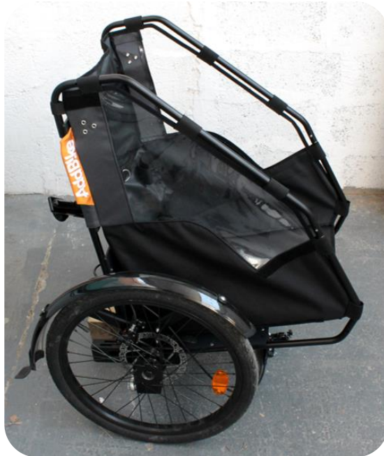
Abbildung 11 – Anbringung der Oberrohre an die Rückenlehne
