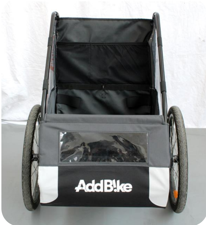
Abbildung 17b – Anbringung des unteren Textils am Modul
