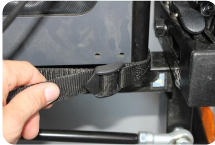
Abbildung 8 - Festziehen der unteren Schlaufe des Textilteils
