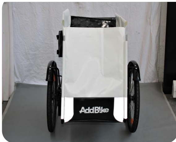
Abbildung 7 - Einsetzen des Textilteils
