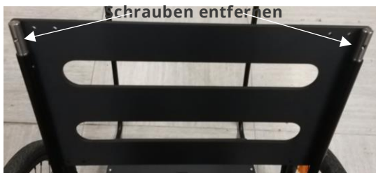
Abbildung 4 – Entfernen der Schrauben der Sitz- und Rückfläche
