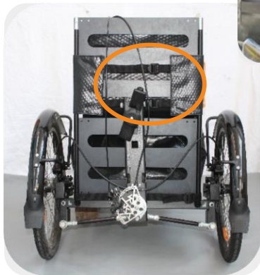
Abbildung 9 - Spannen des Textilteils
