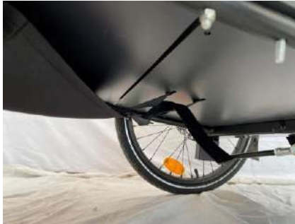
Abbildung 20 – Festziehen des Gurtes des vorderen Textilteils
