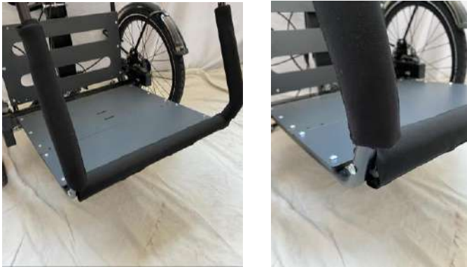
Abbildung 8 - Einrichten der unteren Querstange
