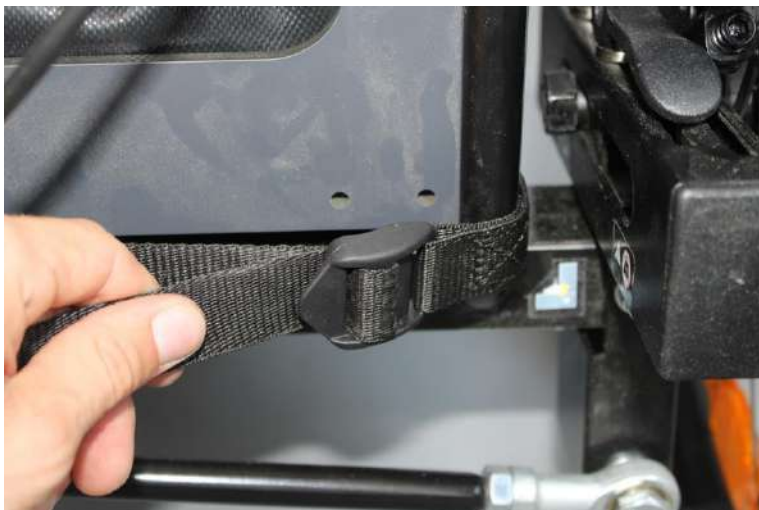
Abbildung 10 – Festziehen der unteren Schlaufe des Textilteils
