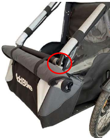
Abbildung 19 - Befestigung des vorderen Textilteils
