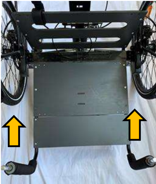
Abbildung 6 - Einführen der Vorderrohre in die Ladefläche
