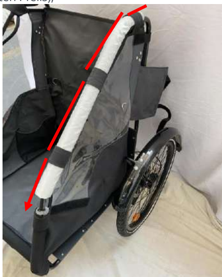
Abbildung 11 – Einführen der Oberrohre durch die Textilschlaufen
