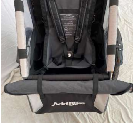
Abbildung 24 – Verstauen der Abdeckung auf der Vorderseite des Moduls
