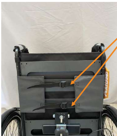
Abbildung 15 – Festziehen der hinteren Gurte
