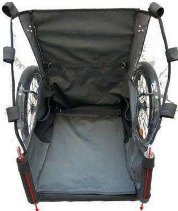
Abbildung 9 - Einfügen des Textilüberzugs
