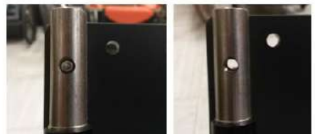
Abbildung 5 – Zu entnehmende Schrauben der Rückenlehne und Ladefläche
