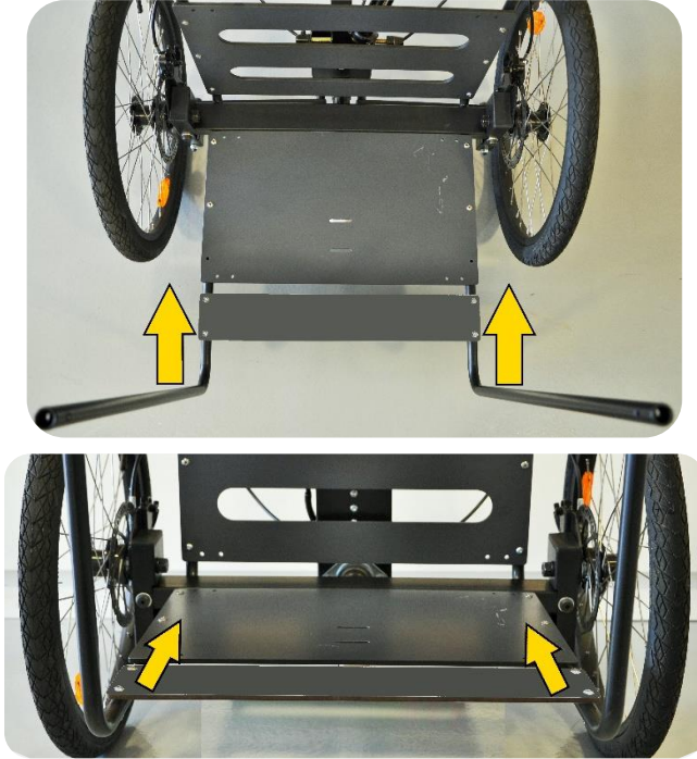
Figure 5 - Insertion des tubes bas dans l'assise
