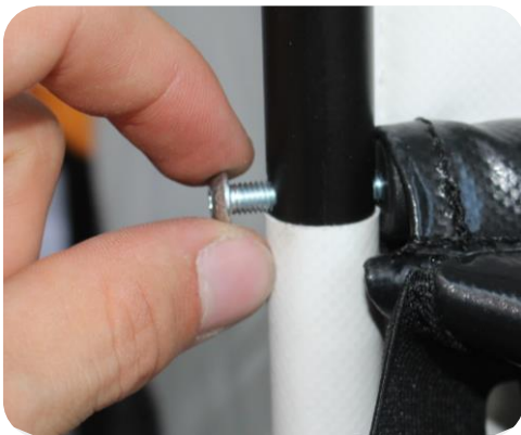
Figure 13b - Montage de la barre transverse
