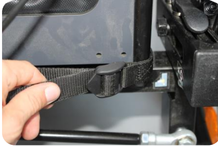
Figure 8 - Serrage de la sangle basse du textile
