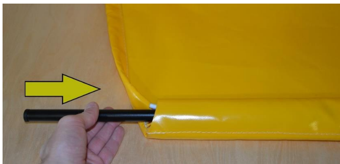
Figure 13 – Insertion de la barre transverse dans le fourreau du couvercle textile
