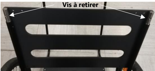
Figure 4 – Vis à retirer de l'assise et du dossier
